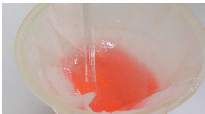
Образовавшиеся парафины в необработанном дизельном топливе закупоривают кофейный фильтр.
