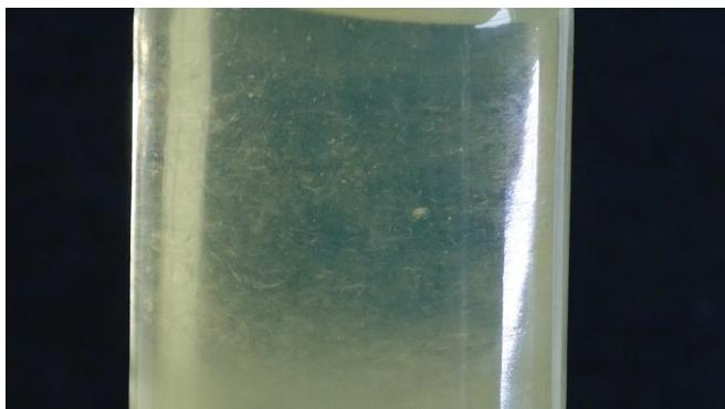
Кристаллы парафина в необработанном дизельном топливе.
