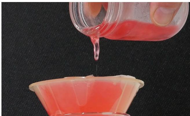
Образование парафина в необработанном дизельном топливе не выдерживает заливки.
