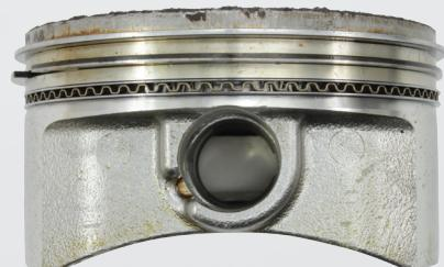
Поршень и кольца практически не имеют отложений и износа после 500 часов испытаний в экстремальных условиях в двигателе Kawasaki \* FX 730 V.
